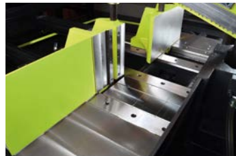
Hydraulisches Doppelspannsystem mit geteiltem und schwimmend gelagerten Spannstock
