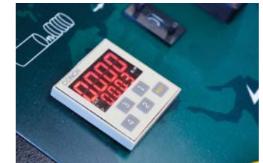
Digitaler Werkstückzähler mit Funktion zur automatischen Maschinenabschaltung
