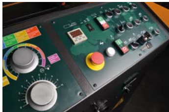
Ergonomisches Bedienpult mit PLC-Steuerung für alle hydraulischen und elektrischen Funktionen
